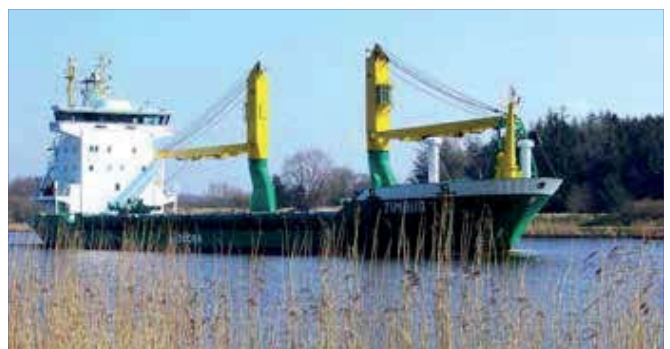
Extrem schwere Ladegüter werden häufige mit zwei Ladebäumen gleichzeitig von Bord gehievt.
