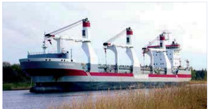
Die „Nassauborg“ ist ein Schwergut-Frachter zum Transport schwerer Güter – mit eigenen Kränen
