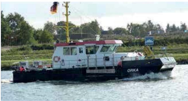
Das Peilschiff „ORKA“ sucht den Kanalgrund nach gefährlichen Gegenständen ab
