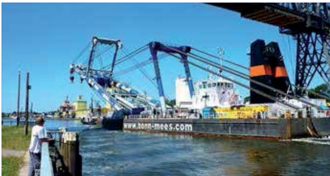
Dieser schwimmende Schwerlastkran kann ganze Schiffe heben und wird bei Haverien eingesetzt.
